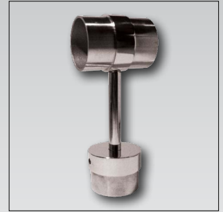
INOX 165 (43) AISI-316 Conexión pasamano, altura regulable Ø 43 x 1,5mm PULIDO ESPEJO
