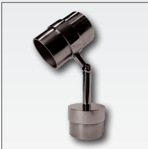
INOX 166 (43) AISI-316 Conexión pasamano, altura y ángulo regulable Ø43x1,5mm PULIDO ESPEJO
