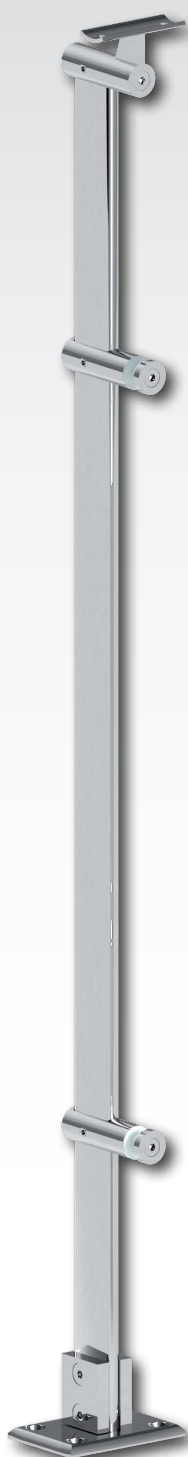
INOX 1110 (43) AISI-316 Poste de arranque 2 puntos fijación cristal, espesor ajustable, altura 1000 mm. Tubo 40 x 10 x 1,5 mm PULIDO ESPEJO
