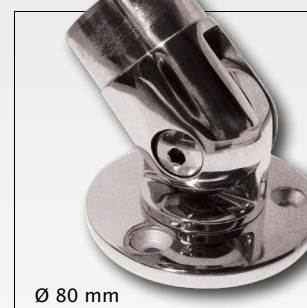
INOX 162 (43) AISI-316 Anclaje regulable para tubo Ø 43 x 1,5 mm - PULIDO ESPEJO
