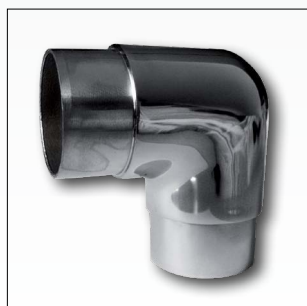
INOX 135 AISI-316 Ángulo 90° tubo Ø 43 x 1,5 mm PULIDO ESPEJO
